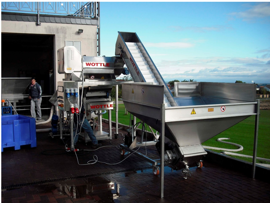
Гребнеотделитель типа АЗ-400К с бункером и телескопическими ножками / Внизу сортировочная система Rolly / Дробилка длиной 750 мм / Вытеснительный насос V18 / Виноградный пресс или емкость
