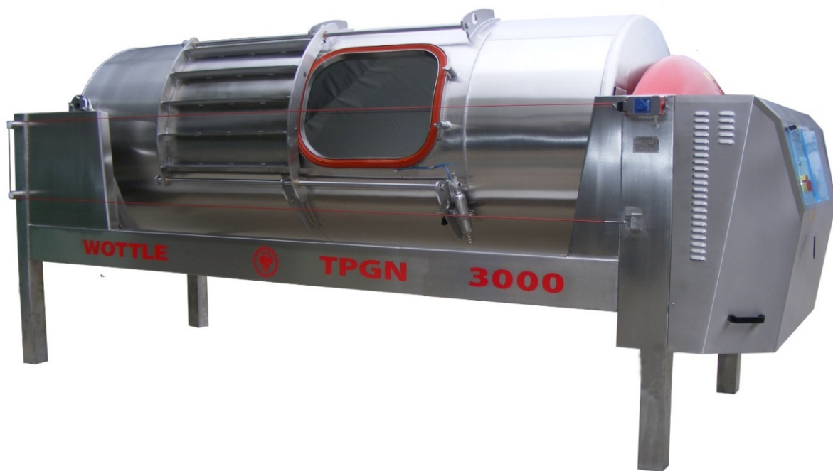
Виноградный пресс типа TPN 5000 с передвижным листом и ванной для сбора сока. Загрузка пресса происходит из прицепа-перегрузчика посредством желоба или из прицепа- перегрузчика через гребнеотделитель типа А4-560К, затем в дробилку и через желоб в пресс. Выгрузка выжимок - в ящики
